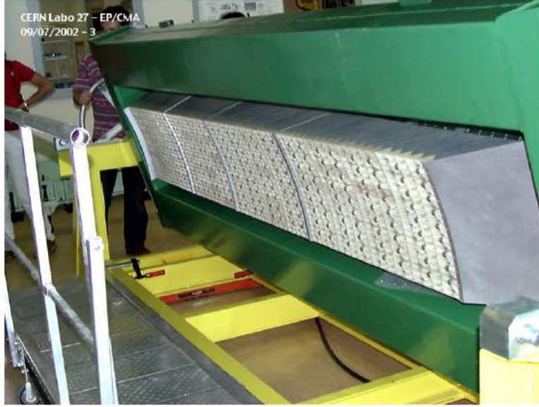
Figura 3.7: Super-módulo real que será montado no ECAL.
