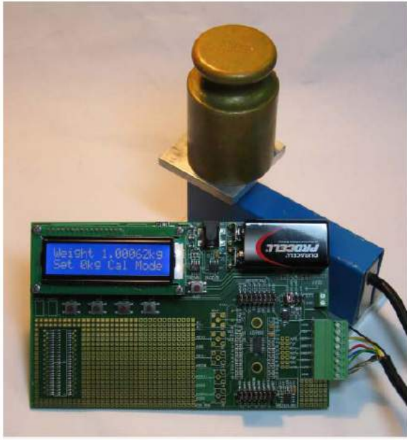
图2. 采用AD7191的电子秤系统
