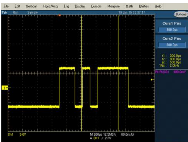
图6. EVAL-CN0373-EB1Z板上RS-232端口的ISOTxD信号
