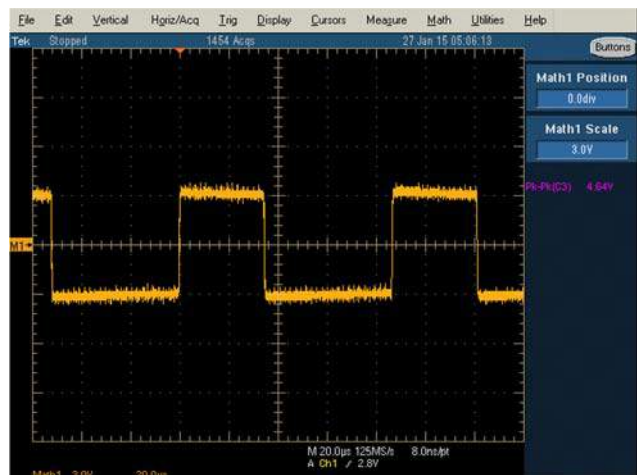
图9. EVAL-CN0373-EB1Z板上RS-485端口的Y-Z数学波形
