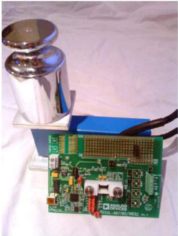
图2.采用AD7780的电子秤系统设置
