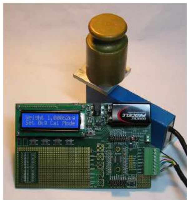
图2.采用AD7195 的电子秤系统设置
