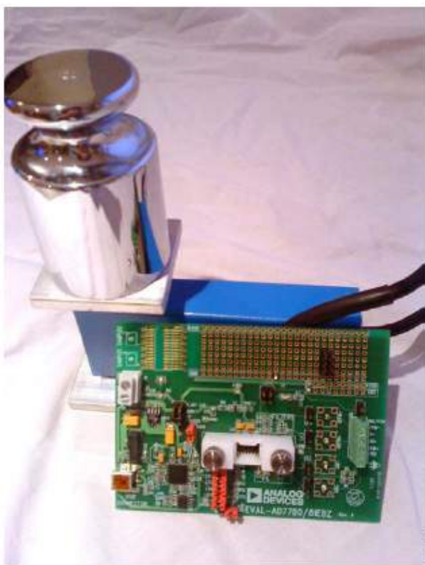
图2.采用 AD7781 的电子秤系统设置
