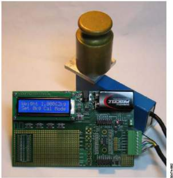
图 2. 采用 AD7192 的电子秤系统
