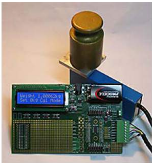
图2.采用 AD7190 的电子秤系统设置
